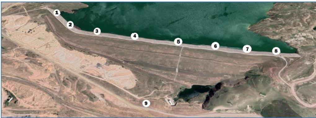
**Рис. 1. Точки сейсмических измерений, проведенные в разных частях плотины**
