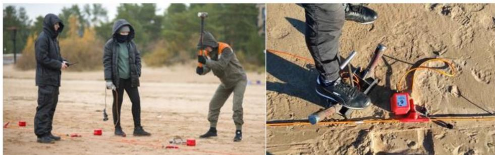
**Рис. 3 Воздействие продольных колебаний (слева), многокомпонентное воздействие колебаний (справа)**
