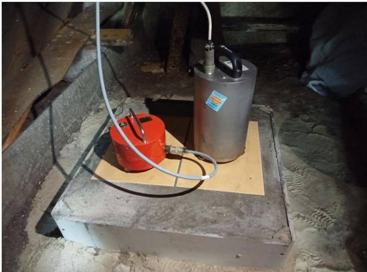
Рисунок – А) Место установки сейсмической станции **KRCH**; Б) Регистратор RefTek 130; В) Сейсмическая станция с датчиком Guralp 3T.
