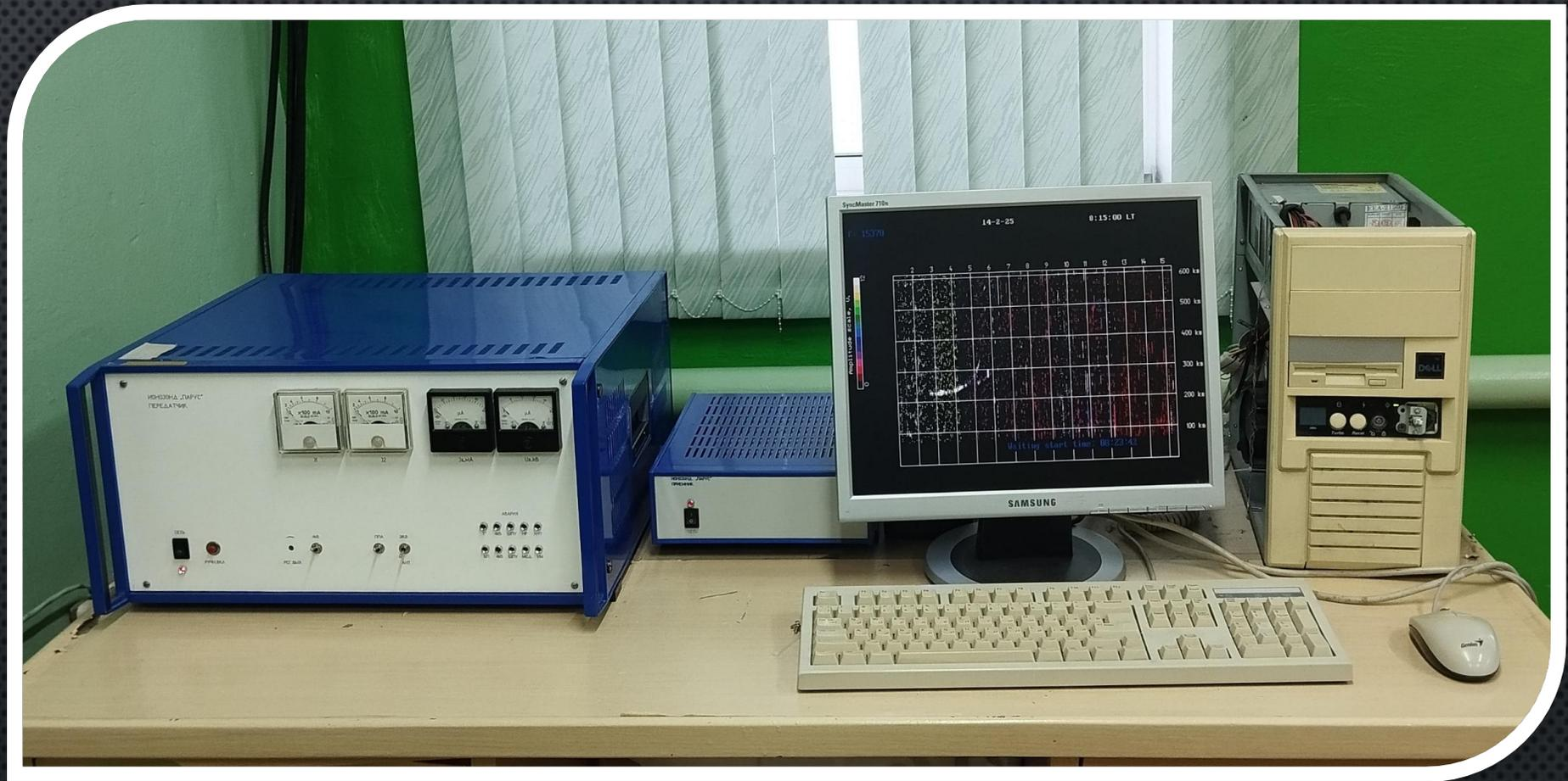
Изначально данные получали с помощью быстродействующего регистрирующего устройства МИС-5, в 2022 году был установлен цифровой ионозонд «Парус», представляющий собой программно-управляемый комплекс с антенной системой, предназначенный для вертикального электромагнитного зондирования ионосферы
