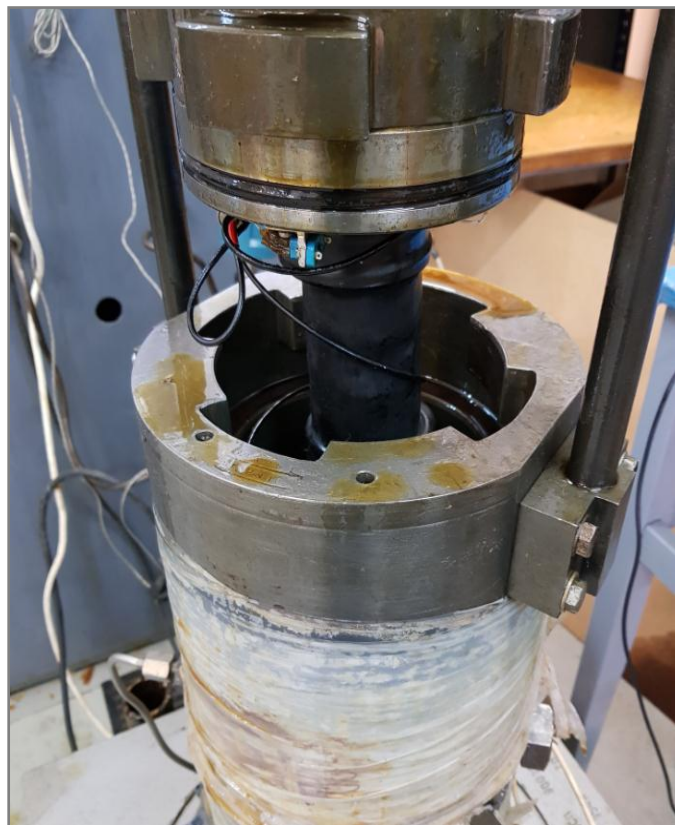
Образец в термоусадочном рукаве перед погружением в камеру всестороннего сжатия
