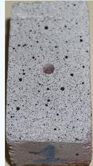
Пример образцов сильвинита с отношением сторон 2/1
