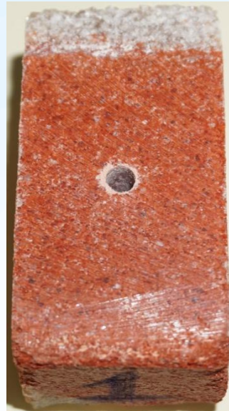
Пример образцов сильвинита с отношением сторон 2/1
