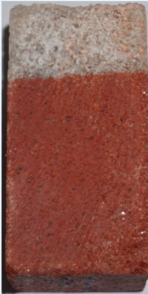
Пример образцов сильвинита с отношением сторон 2/1
