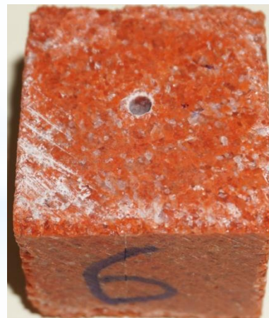
Пример образцов сильвинита с отношением сторон 1/1
