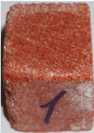
Пример образцов сильвинита с отношением сторон 1/1
