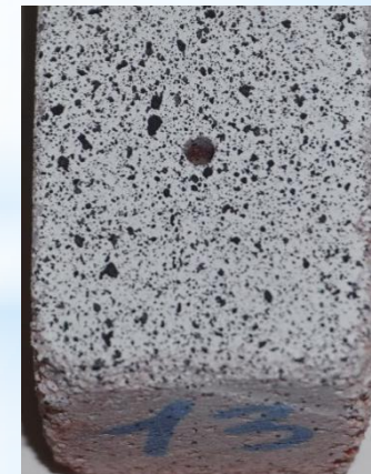
Пример образцов сильвинита с отношением сторон 1/1
